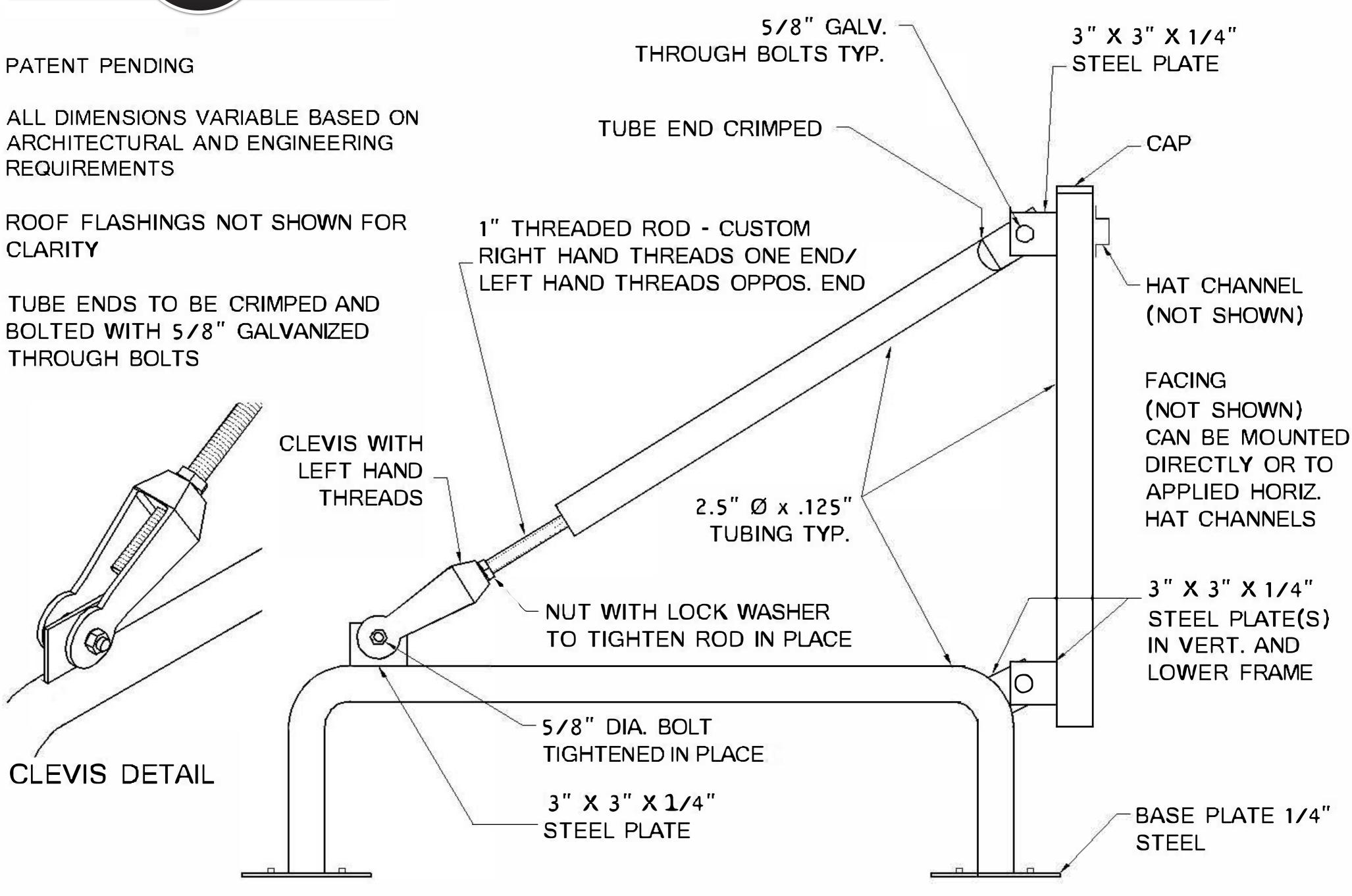
SIDE VIEW- ADJUSTABLE EQUIPMENT SCREEN FRAME HEAVY DUTY
